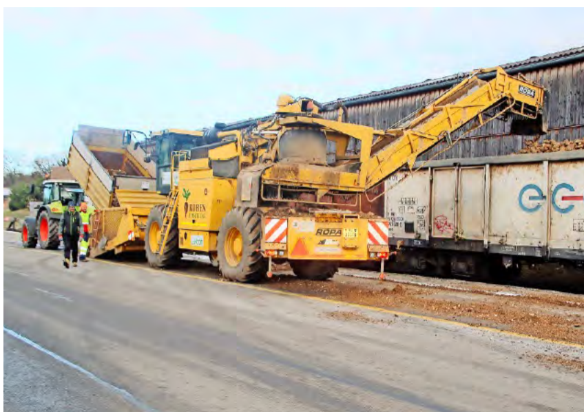
Hinter der «Rübenratte» steckt eigentlich eine Rübenmaus, welche für den Feldverlad auf Rüben-Anhängerzüge konstruiert wurde. Bild: Roland Müller
